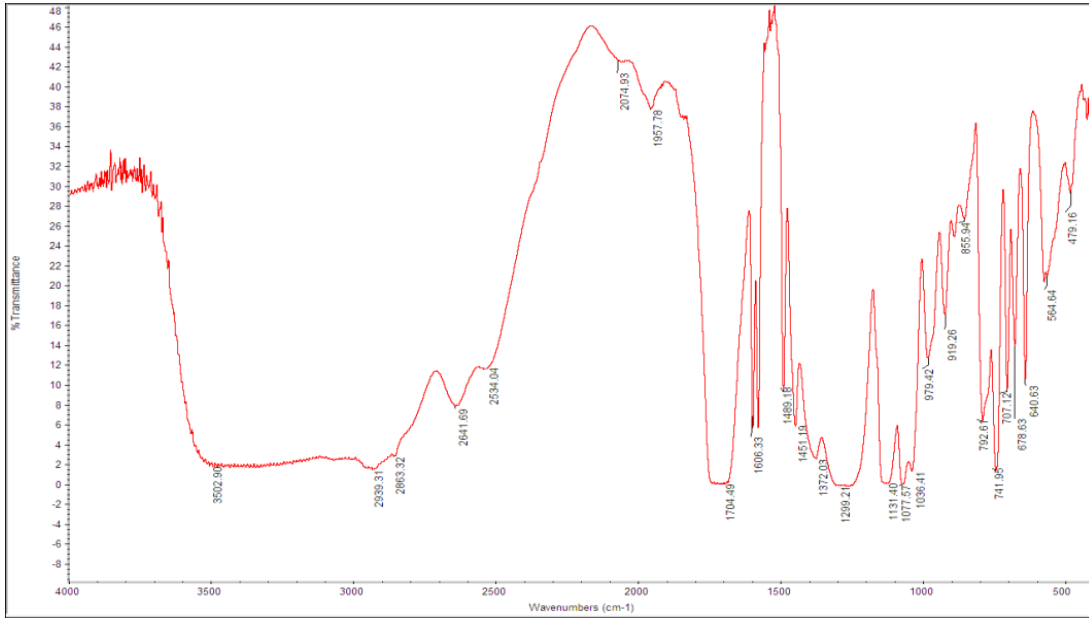
(c). FTIR spectral of medium delonix regia –alkyd resin (MDROAR).
