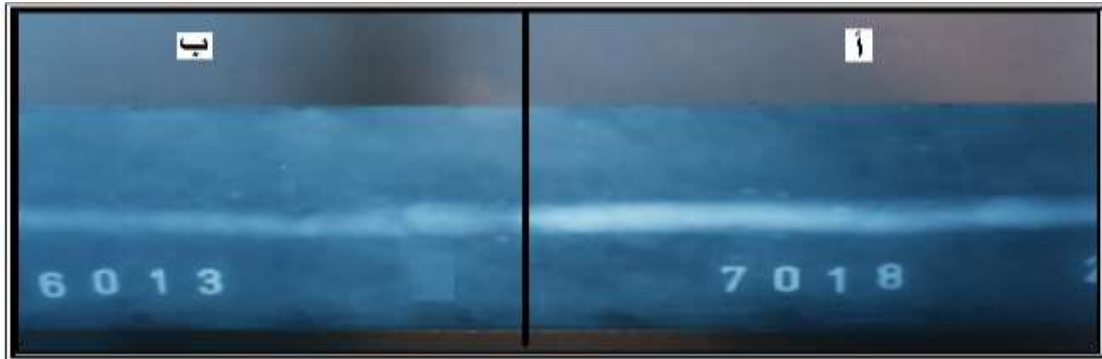
الشكل (6) لوصلة غير متشابهة من ( St-St +C-St ) باستخدام أقطاب لحام (E6013) و(E7018)
