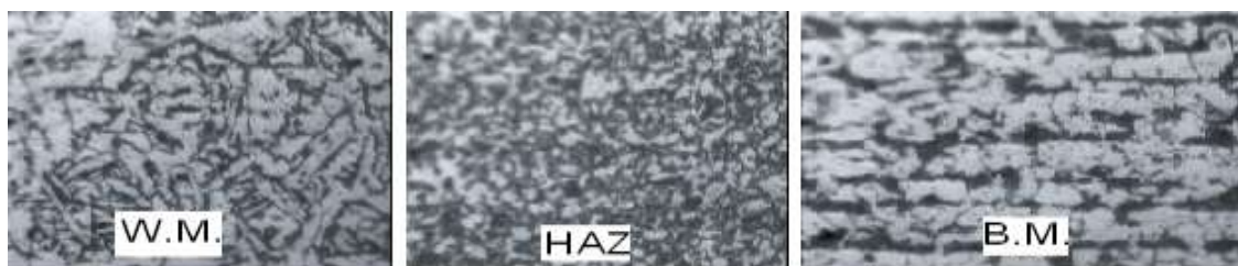
شكل (9) التركيب المجهرى للمناطق المختلفة في وصلة لحام (SMAW) للفولاذ الكربوني المنخفض (A516) باستخدام قطب (E6013). قوة التكبير (250X).
