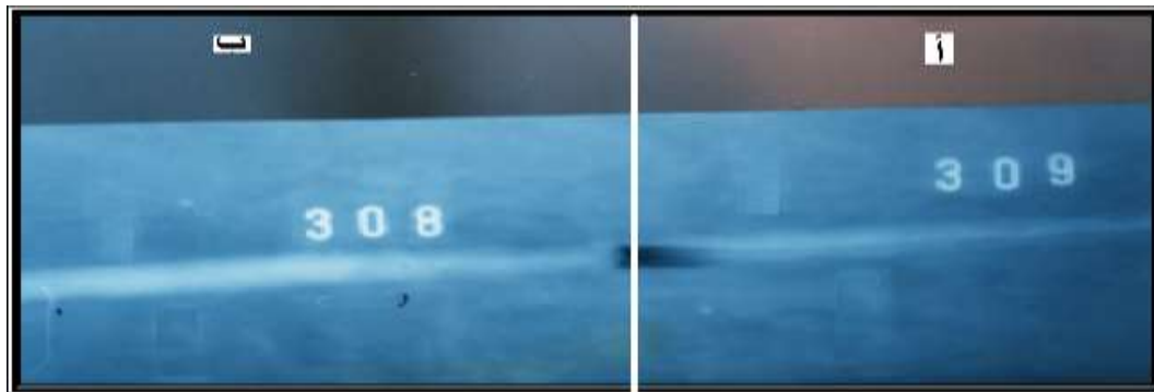
الشكل (7) لوصلة غير متشابهة من ( St-St +C-St ) باستخدام أقطاب لحام (E308L) و(E309L)
