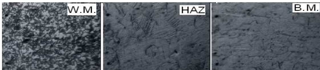
شكل (11) التركيب المجهرى للمناطق المختلفة في وصلة لحام (SMAW) للفولاذ المقاوم للصدأ (316L) باستخدام قطب (E6013). قوة التكبير (250X).
