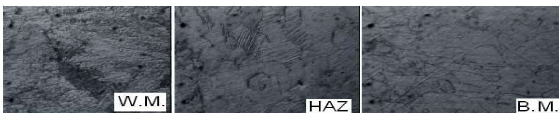
شكل (10) التركيب المجهرى للمناطق المختلفة في وصلة لحام (SMAW) للفولاذ المقاوم للصدأ (316L) باستخدام قطب (E7018). قوة التكبير (250X).
