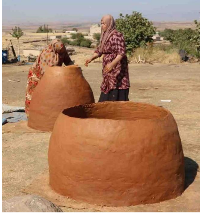
صورة (٢) تبين طريقة عمل التنور في شمال العراق ومناطق أعالي الفرات في بلاد الشام، وتظهر الطينة الحمراء المستخدمة في عمله.
