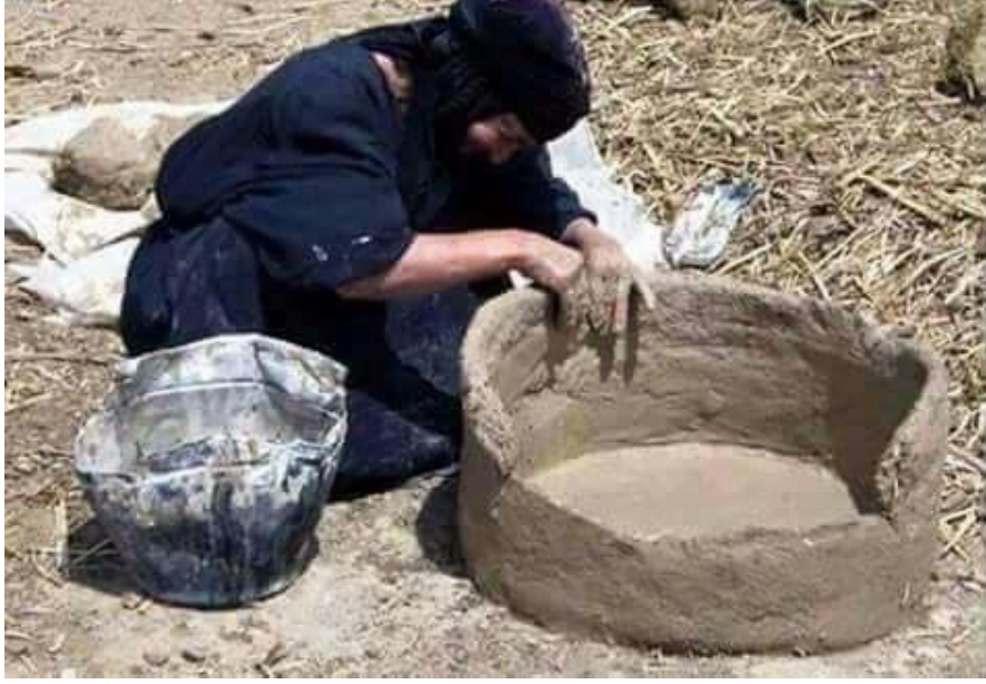
صورة رقم (٤) تدين كيفية عمل التنور في جنوب العراق ونوعية الطين المخلوط بالقش المستخدم في عمل التنور
