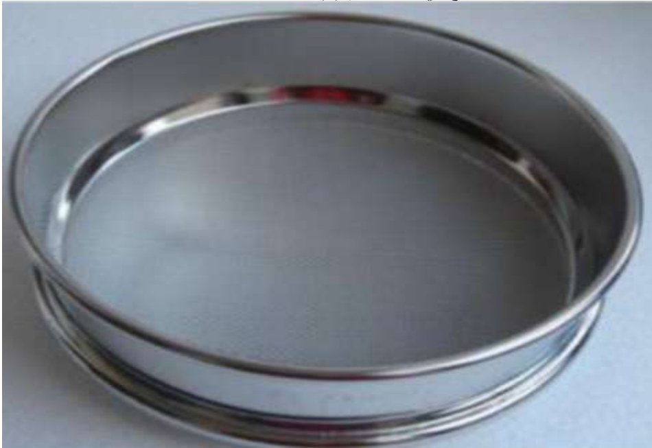
شكل (3): غربال 1.18 ملم لقياس نعومة الجص
