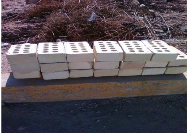
صورة رقم - 1 : بعض نماذج الطابوق المرجعي من المعمل
