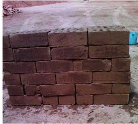
صورة رقم- ٢ : نماذج من لين الطابوق المصنع الرطب
