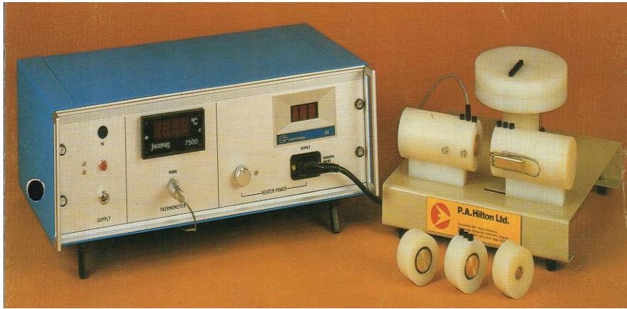
شكل رقم (1) يبين صورة توضيحية لجهاز قياس الموصلية الحرارية
