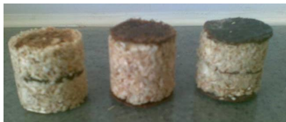
شكل رقم (4) يبين نماذج من عينات نشارة الخشب مع ألياف النخيل
