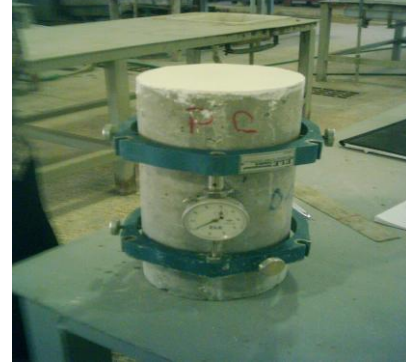
شكل رقم (1) (a) الجهاز المستخدم في الفحص، (b) شكل لنموذج فاشل
