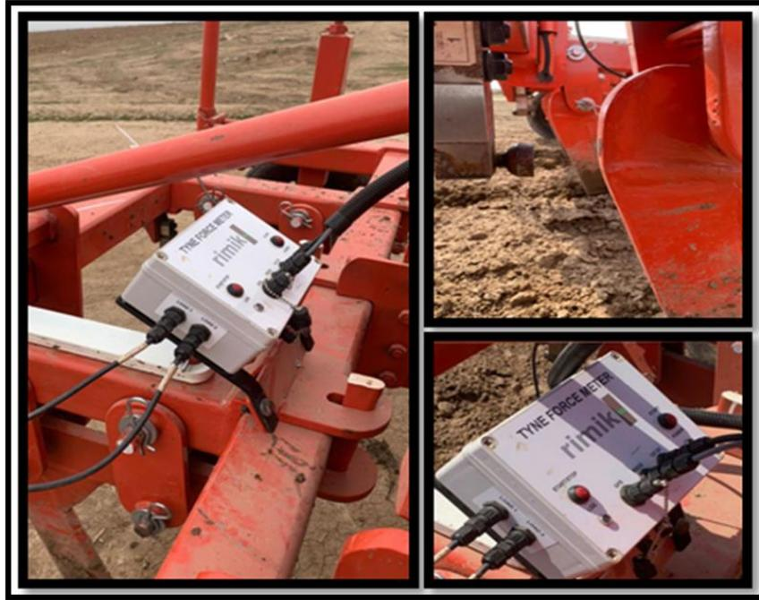
شكل (2) يوضح اجزاء جهاز قوة السحب
