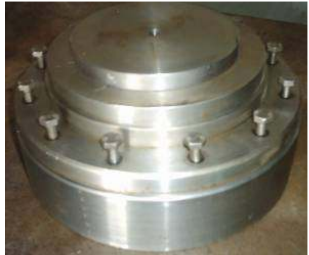
الشكل (5) الخرامة المسطحة ومثبت النموذج والقالب والمستخدمين لإجراء عملية الانفعال المسبق في المط ثنائي المحور المتساوي
