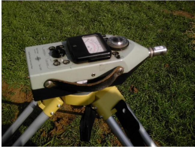
الشكل ( ١ ) جهاز قياس شدة الضوضاء المستخدم في التجربة
