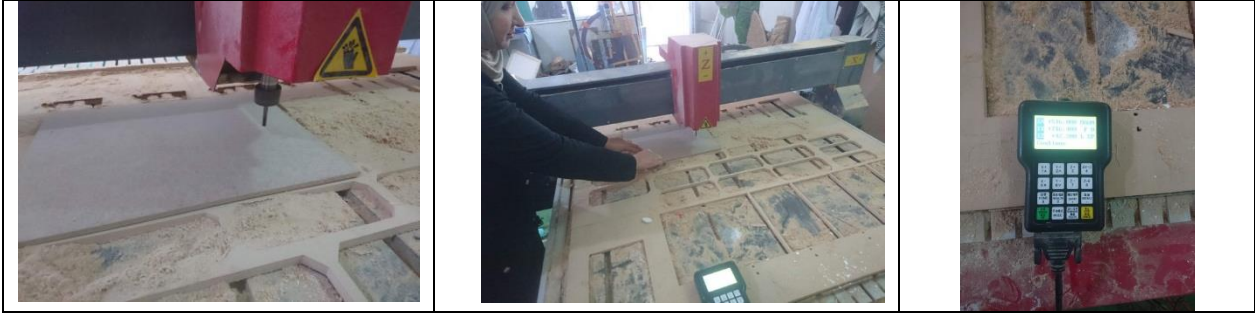
شكل (٢) يوضح مراحل الحفر على الخشب بواسطة مكائن CNC
