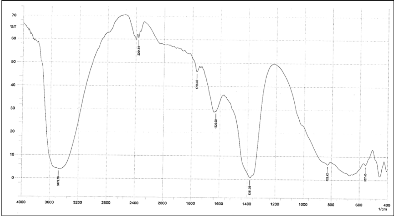
الشكل ( 2 ) : طيف الأشعة تحت الحمراء لطبقات المغنيسيوم/الألمنيوم ثنائية الهيدروكسيد
