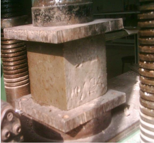
صورة رقم 2 عملية فحص مكعب الانضغاط المستخدم في الدراسة
