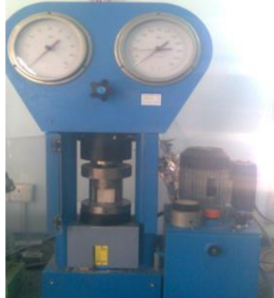
صوره رقم(3): النموذج في جهاز فحص الضغط
