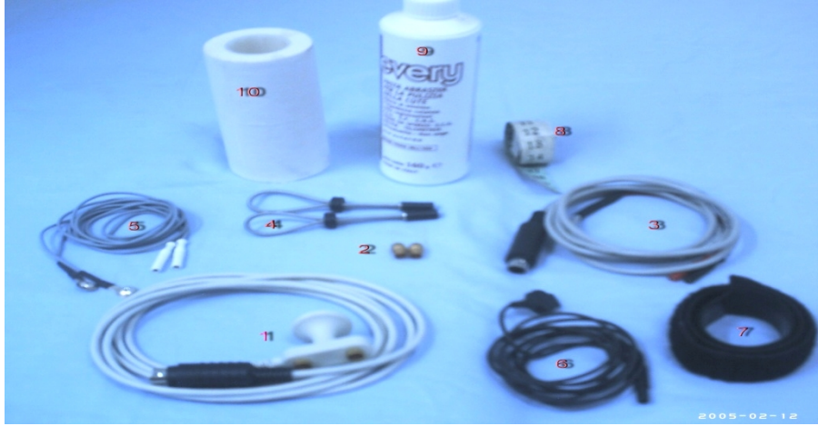
صورة ( ٢ ) توضح الأقطاب والكيبلات المستخدمة وشريط القياس
