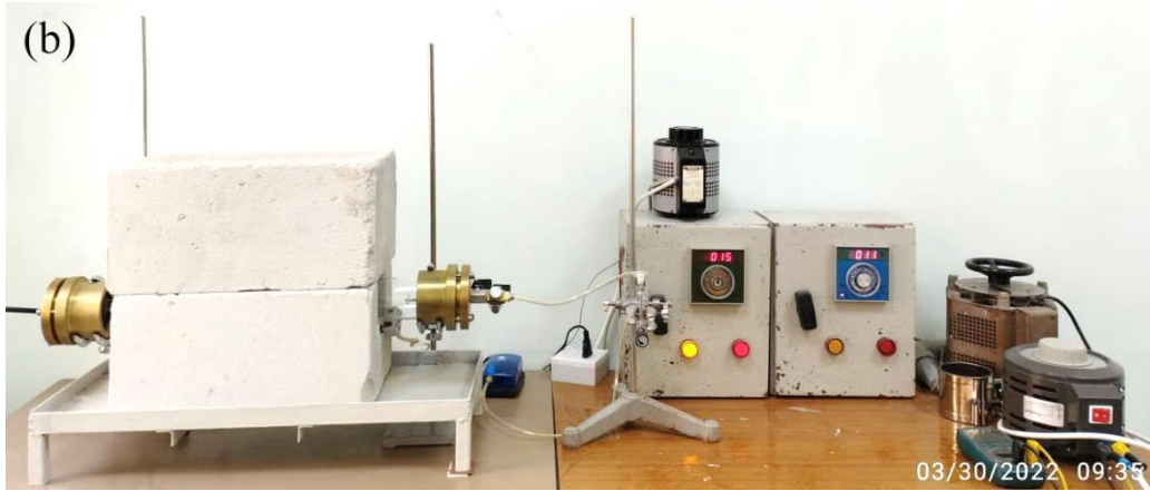
الشكل (1): (a) رسم تخطيطي لمنظومة (TCVD). (b) صورة رقمية للمنظومة مع اهم الأجزاء التي تتكون منها.
