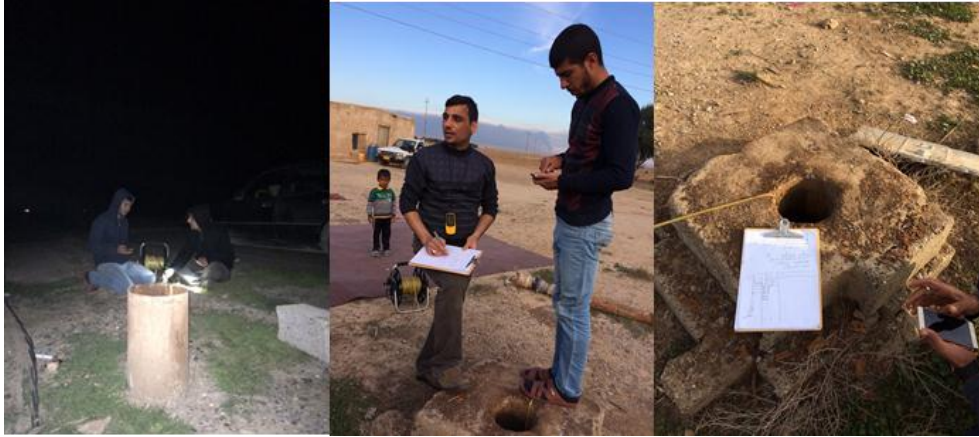
لوحة رقم (1) تبين عملية قياس منسوب المياه الجوفية بواسطة Groundwater depth detector.
