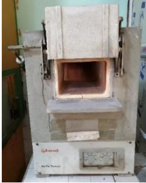
الشكل ( 2 ) الفرن الكهربائي المستخدم في عملية التلدين
