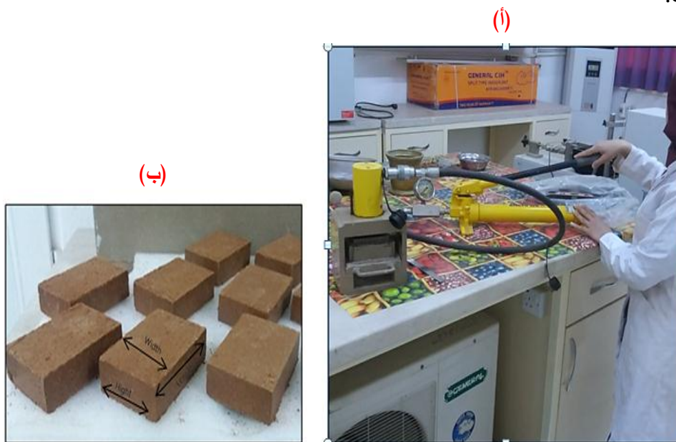
الشكل 2: (أ) يبين جهاز CINVA-RAM لإنتاج الطابوق الترابي المضغوط، (ب) يبين نماذج لقالب الطابوق الترابي المنتج.
