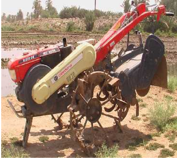
شكل(1): الحراثة بوجود الماء باستخدام المحراث الدوراني (Rotary plow).
