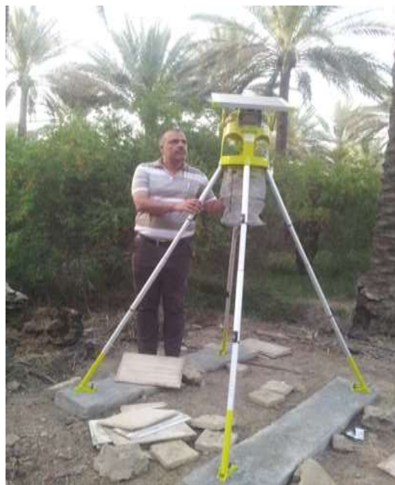
مصائد ضوئية تعمل بالطاقة الشمسية تستخدم لأغراض المراقبة والتحري والمكافحة لحفارات النخيل
