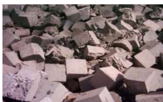
صورة رقم 1 نماذج مكعبات مفحوصة وتالفة
