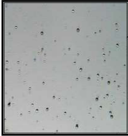
الشكل (4) يوضح اثار جسيمات الفا في الكاشف (CR-39)
