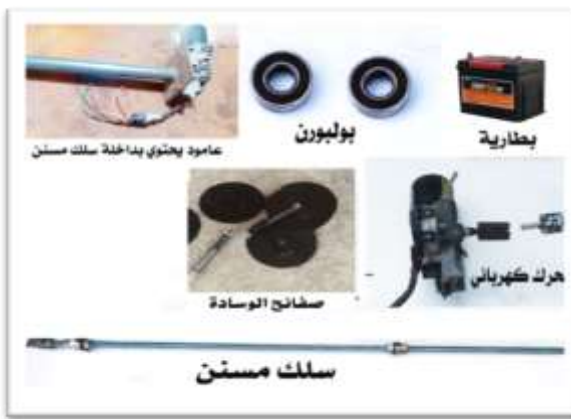
الشكل (١) يوضح مكونات الجهاز المقترح
