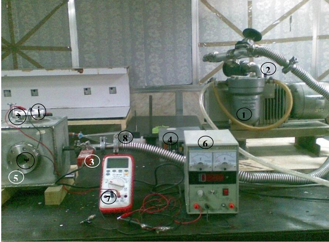
شكل ( 1 ) منظومة التحسس للغازات (1- مضخة تفريغ نوع Rotary. 2- أنابيب توصيل 3- متحسس قياس 4- قارئ الضغط. 5 - حجرة وضع العينات ( Chamber ) وفيها: أفتحة لضخ وتفريغ الغازات ب- فتحة تستخدم كـ ( Glass window ) لأخذ الإشارة. 6- مجهز قدرة ( DC . Power supply ) . 7- قارئ مقاومة. 8- حامل حديدي لوعاء تكوين الغاز.)
