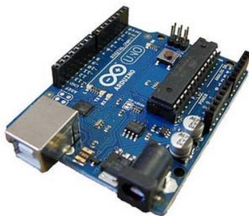
FIG. 3. ARDUINO UNO BOARD.
