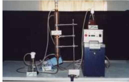
شكل (1) منظومة التخمر المستمر باستخدام الخلايا المثبتة
