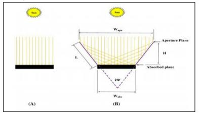
FIG.1 . A- PV MODULE, B- V-PV MODULE [12]
