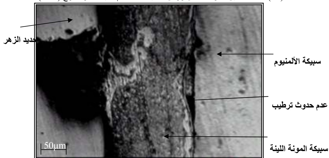
شكل (16) : منطقة ربط سبيكة الألمنيوم وحديد الزهر ( سبيكة 40A وزمن مقداره 10min.)
