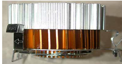
شكل رقم (2) مبدد حراري من الألمونيوم والنحاس
