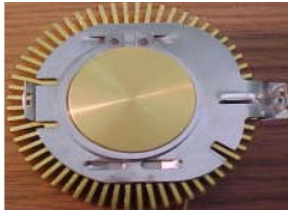
شكل رقم (2) مبدد حراري من الألمونيوم والنحاس
