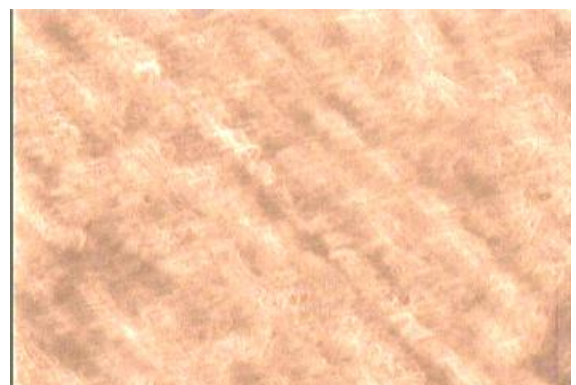
الشكل (7) طبوغرافية سطح عينة معاملة محلوليا بدرجة (500C°) بقوة تكبير (600X)
