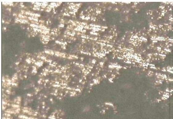
الشكل (4) طبوغرافية سطح عينة غير معالجة حراريا معرضة لوسط التآكلي (3%HCl) في درجة حرارة (80°C)
