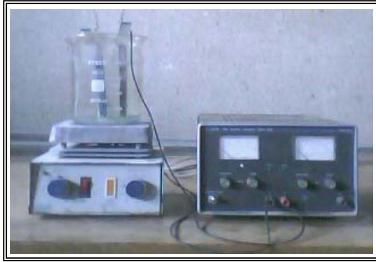
الشكل (1-1) الخلية الالكتروليتيه المستخدمه في الترسيب الكهربائي .
