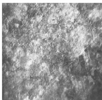
تقسية في الزيت مع مراجعة عند 250 °C ، قوة التكبير 250X
