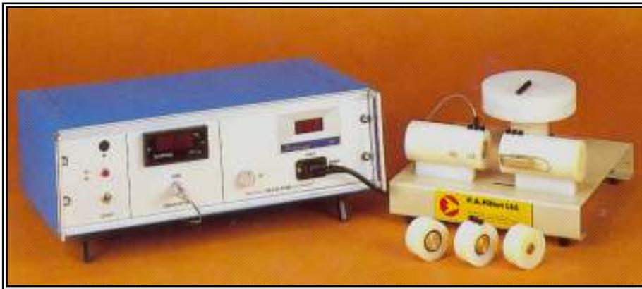
الشكل رقم (2) : جهاز قياس الموصلية الحرارية
