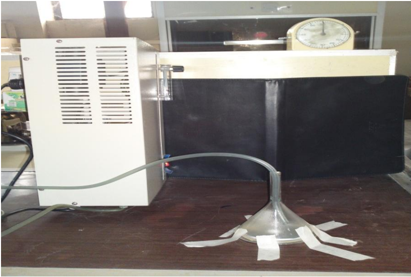
شكل(2): طريقة تعريض الخلايا الخضرية للاوزون باستعمال جهاز توليد الاوزون.
