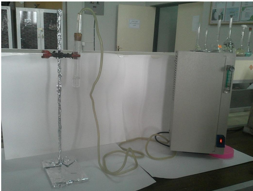
شكل(1): طريقة تعريض العالق السبوري للأوزون*.
