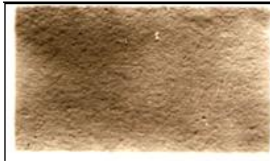
a - صورة المجهر الضوئي للالومينا النقية
