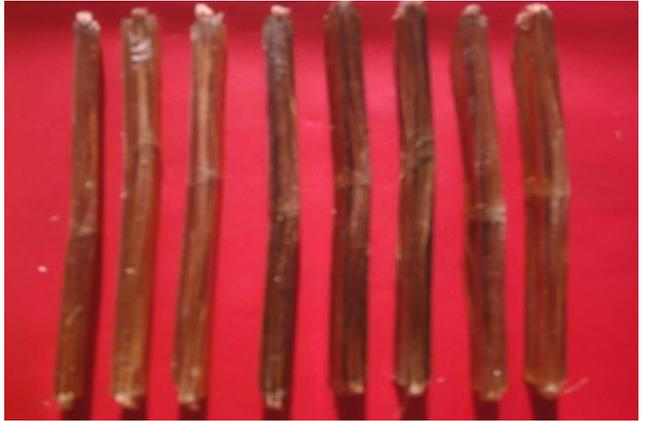
شكل (12) عينات الانحناء للمواد المركبة المقواة باللياف بولي اميد بعد الاختبار .
