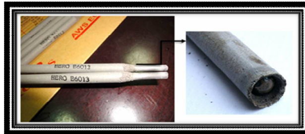
الشكل (٢-٢) يوضح صورة أقطاب اللحام المستخلص منها كاربيد السيليكون.
