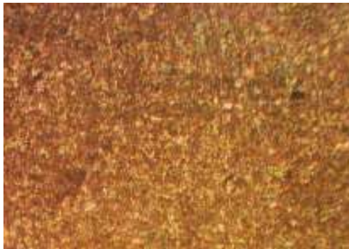
شكل (9-b): عينة الفولاذ واطى الكربون المغمور في ماء الحنفية مع المثبط (400X).
