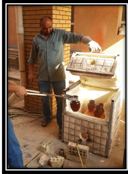
الشكل (١-٥) يبين اخراج القطعة من الفرن باستخدام الماسك (الملقط)
