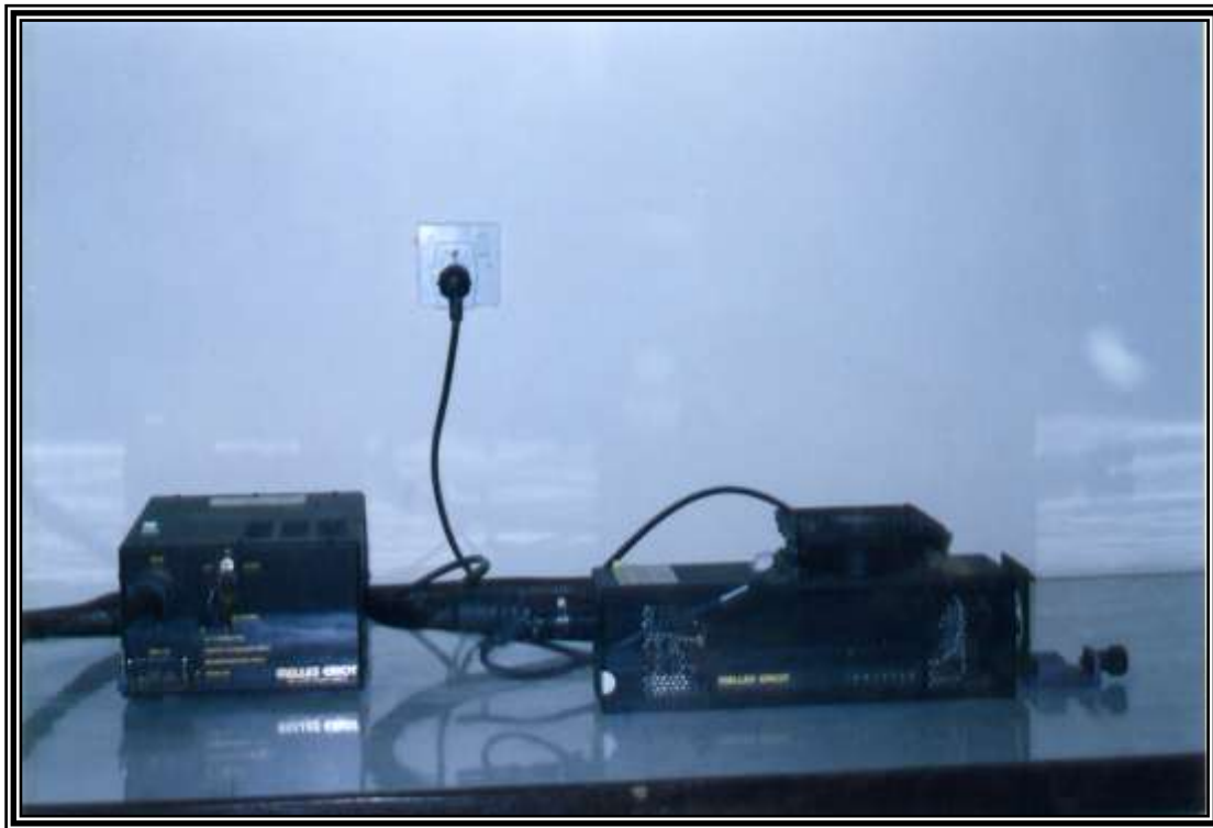
الشكل ( ٢ ) يبين جهاز اشعة ليزر الاركون ذو القدرة 125 mW المستخدم خلال الدراسة
