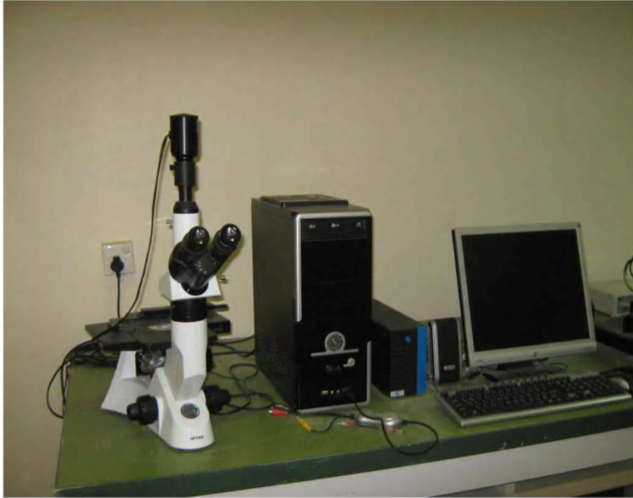
شكل (٥) مجهر فحص وتصوير التركيب الدقيق للعينات
