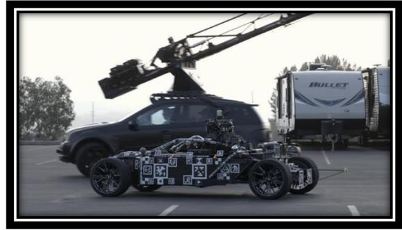
شكل رقم (2) مركبة كهربائية تستخدم لالتقاط حركة السيارة المطلوبة في الفلم
