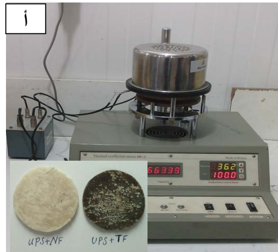
شكل رقم (9) أ-جهاز اختبار معامل التوصيل الحراري ب- نتائج معامل التوصيل الحراري
