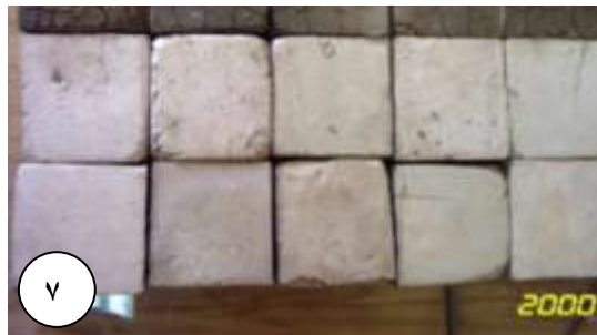
صورة ٧: مجموعة من المكعبات ذات التشكيل الجيد وخالية من التشققات قبل وبعد الفخر للخلطة ٢٥% رمل.
