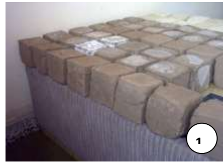
صورة ٢: بعض من نماذج المكعبات المجففة قبل الفخر.
