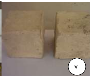
صورة ٧: مجموعة من المكعبات ذات التشكيل الجيد وخالية من التشققات قبل وبعد الفخر للخلطة ٢٥% رمل.
