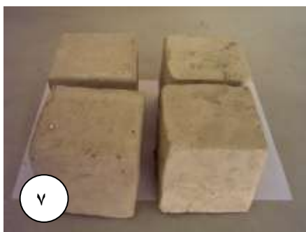
صورة ٥: التشقق قبل الفخر بسبب وجود الجبسوم.
