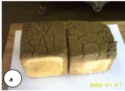
صورة ١: بعض من نماذج المكعبات المجففة قبل الفخر.
