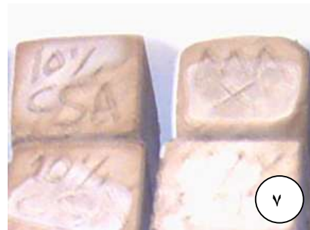
صورة ٦: التشقق بعد الفخر بسبب وجود الجبسوم.
