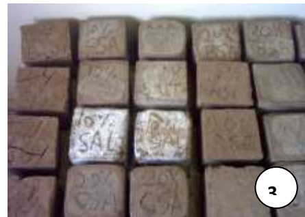
صورة ٦: التشقق بعد الفخر بسبب وجود الجبسوم.
