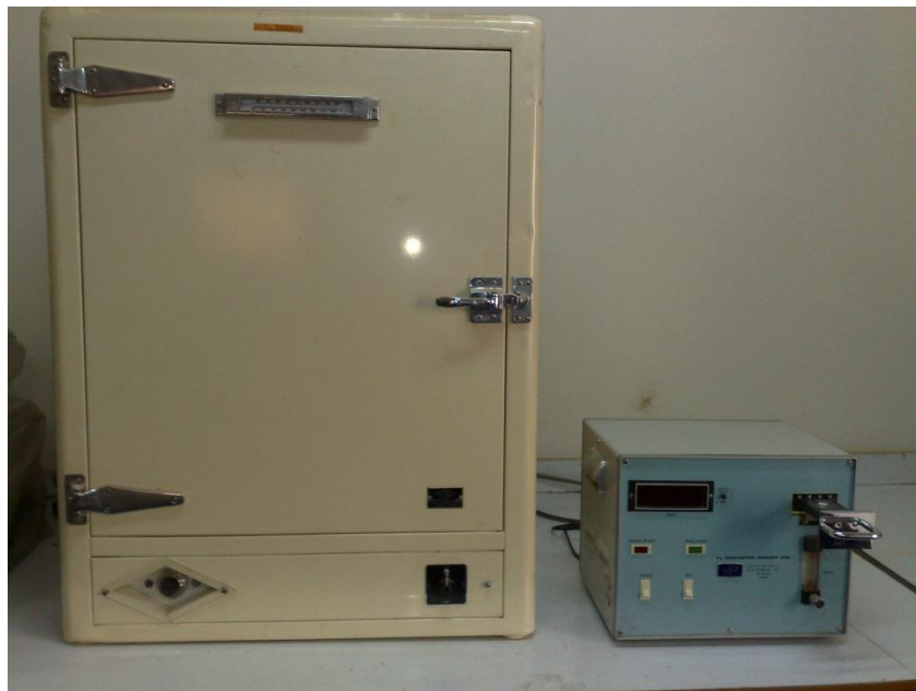
شكل (٢) يمثل جهاز قراءة العدادات وفرن التلدين
