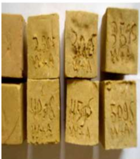
صورة (3) اختفاء الشقوق خلال عمليتي التجفيف والفخر بعد إضافة الرمل والغسل بالحامض والماء
