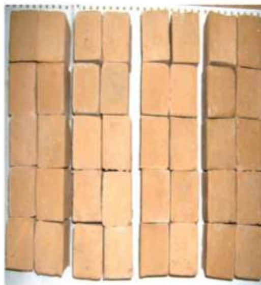
صورة (3) اختفاء الشقوق خلال عمليتي التجفيف والفخر بعد إضافة الرمل والغسل بالحامض والماء
