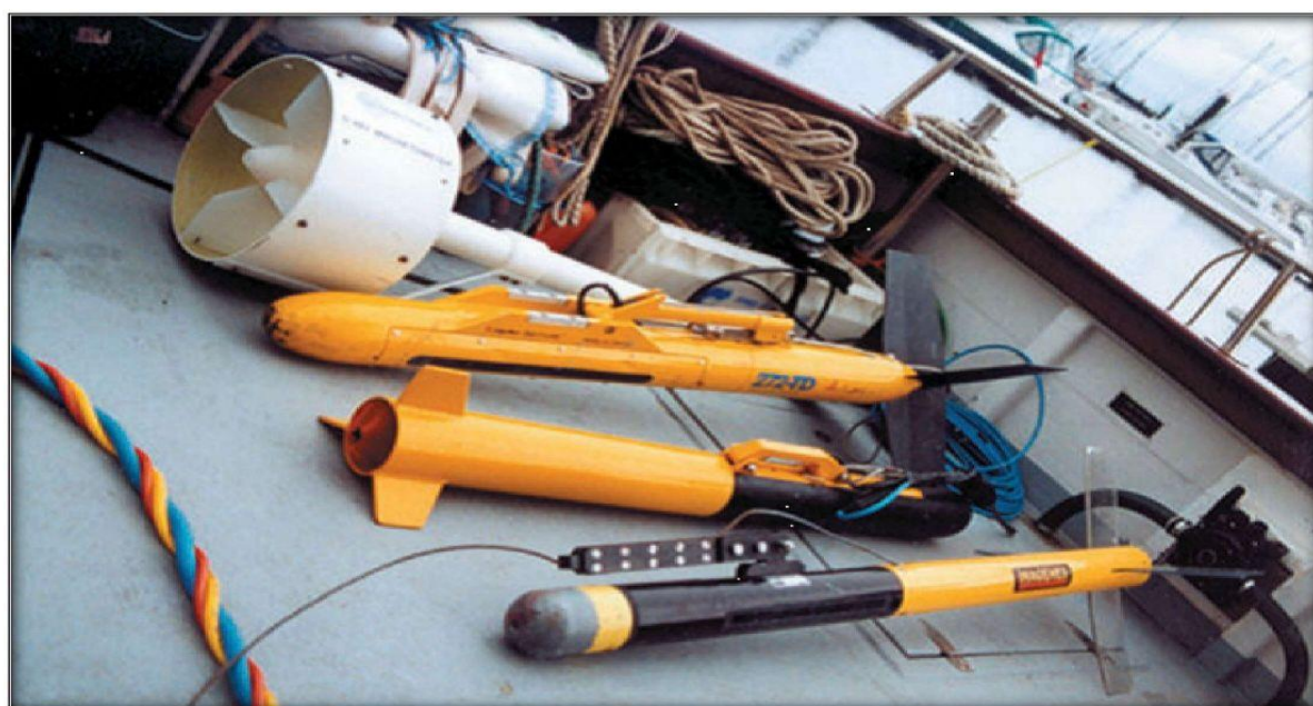
شكل رقم (4) الجهاز الصوتي المستعمل في الكشف عن الآثار الغارقة المصدر: Nautical Archaeology Society, 2009
