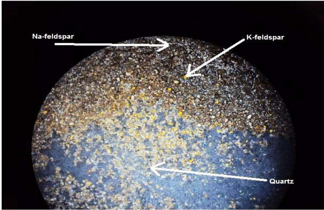
الشكل (8) عينة رمل تكريت ذات مستوى جبسي 5% تحت المجهر الضوئي المستقطب موضحا عليها معدن K-feldspar , Na-feldspar , Quartz قوة التكبير 40x
