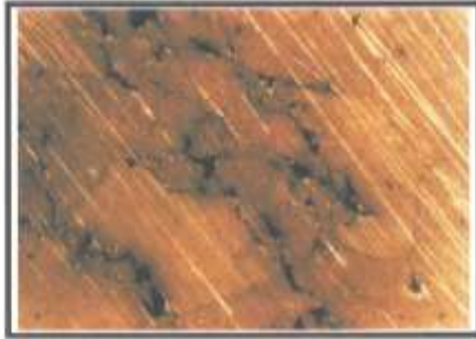
(4-b) المعاملة حرارياً عند ( 1000^{\circ}\text{C} ) لنموذج مختزل لقطر من الصلب
